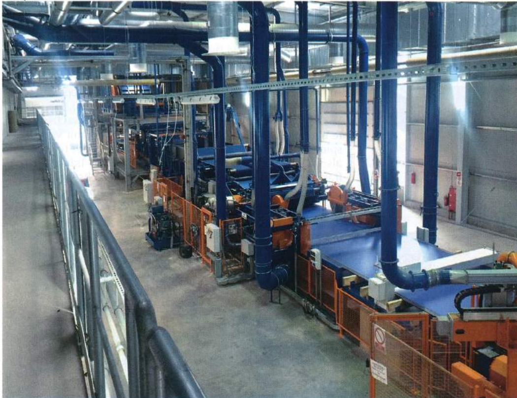
Das Frontende der Anlage mit Vorpresse und Längsbesäumsäge (links)
